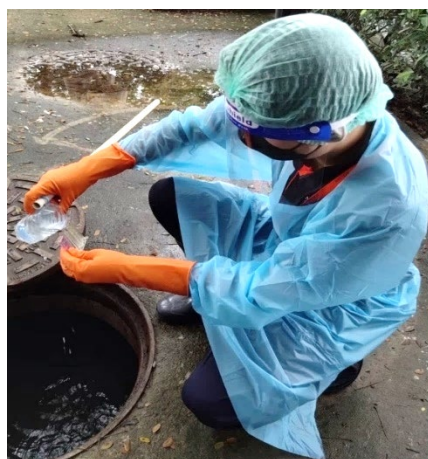
รูปที่ 3.5-1 การเก็บตัวอย่างน้ำเพื่อตรวจสอบประสิทธิภาพระบบบำบัดน้ำเสีย
